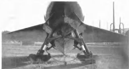
Носовые стойки лыж. Видны штоки амортизаторов. Лыжи в буксировочном положении.
